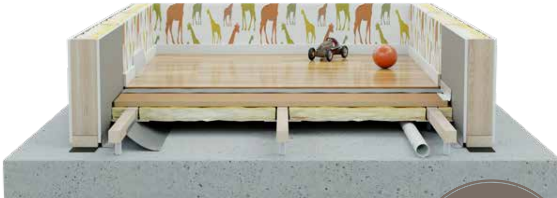
Konstruktion Nivell System Ventilerat golv.
